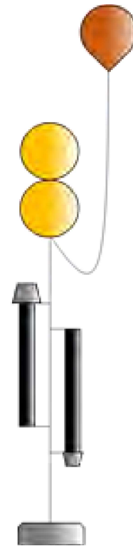
Figur 4 Prinsippskisse av strømmålerigg. AquaDopp Profiler måler oppover i vannsøylen, med ekstra punktmåler som peker nedover. Modifisert skisse fra NS 9424-1:1999. NB: I denne undersøkelsen ble det brukt to punktmålere.
